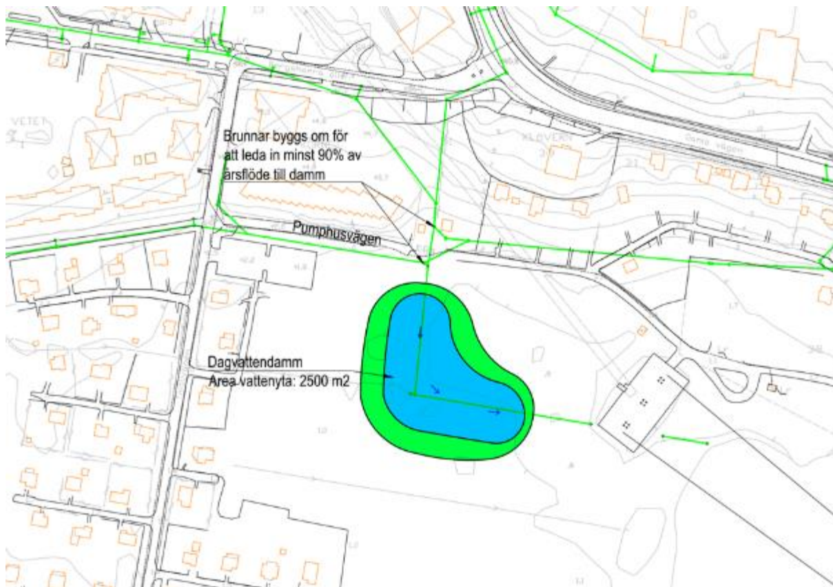
Figur 14. Dagvattendamm vid Pumphusvägen.
