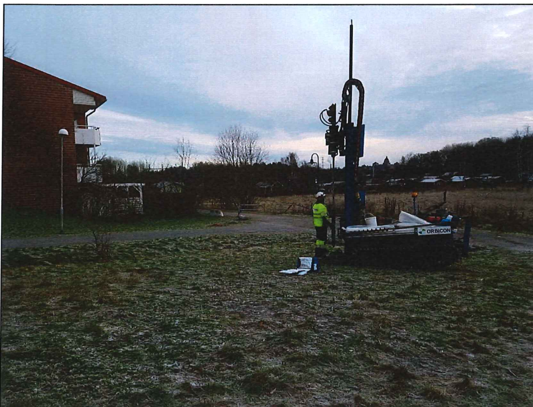
Figur 4. Skruvprovtagning i provpunkt Skr01 i den norra delen av undersökningsområdet.
