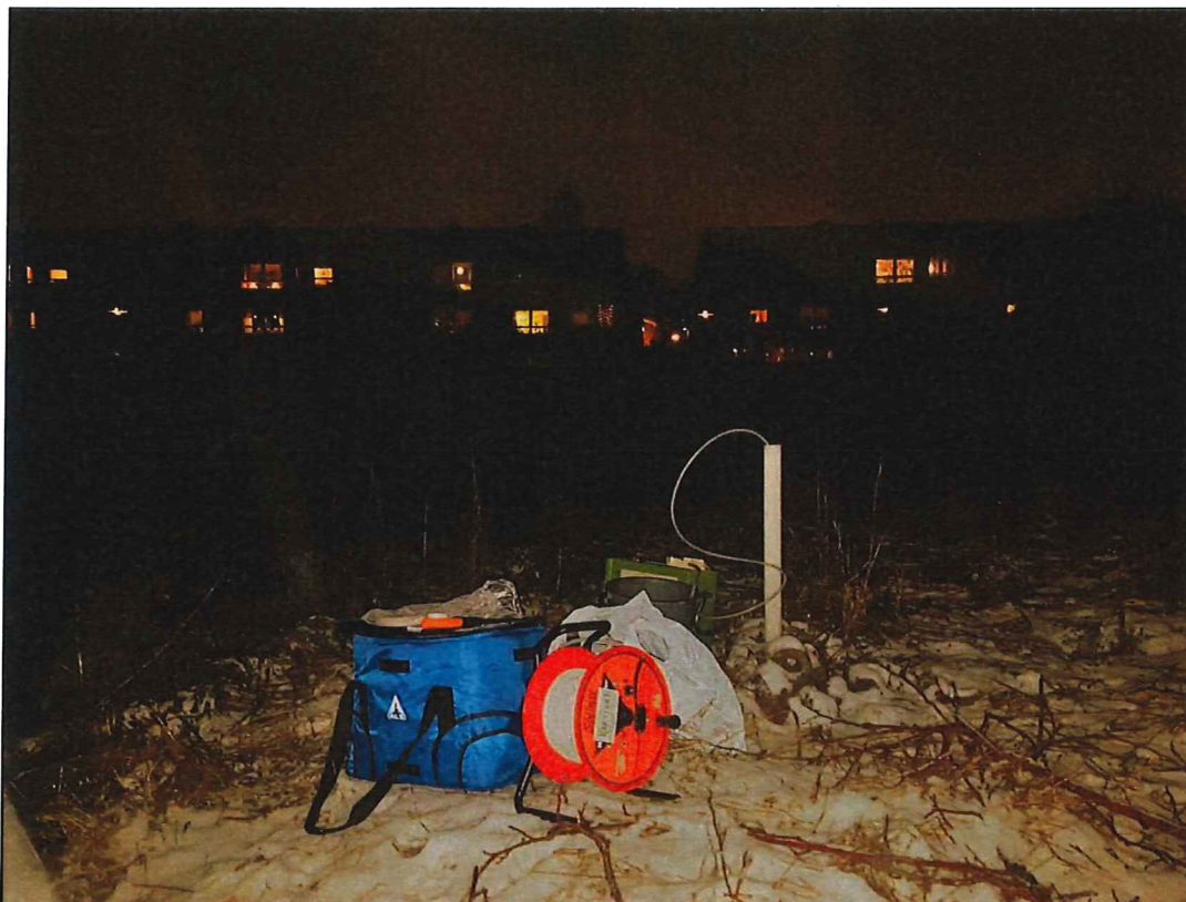
Figur 6. Lodning av grundvattennivån och omsättning av grundvattnet vid provpunkt Skr + GV01.
