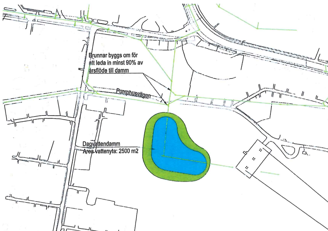
Dagvattendamm vid Pumphusvägen.
