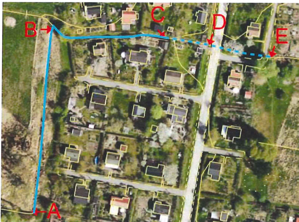
Figur 1 a. Diket som ska rensas. En dikessträcka på ca 160 m planeras att åtgärdas (sträcka A-D, bilaga 2). Sträckan A-C utgörs idag av ett öppet dike och sträckan C-E är kulverterad.
